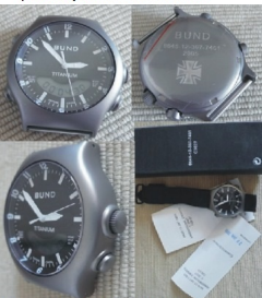
Como curiosidad decir que agujas e índices no llevan ningún material luminescente...La pantalla digital lleva retroiluminación accionada por el pulsador de arriba a la izquierda y en ella se pueden mostrar todos los datos necesarios para el soldado.
