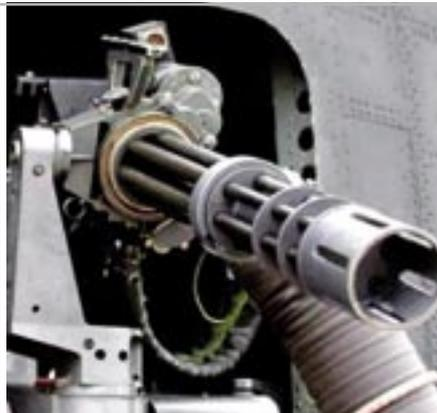
Ametralladora Minigun M134 de 7,62 mm arma don seis cañones rotatorios.
