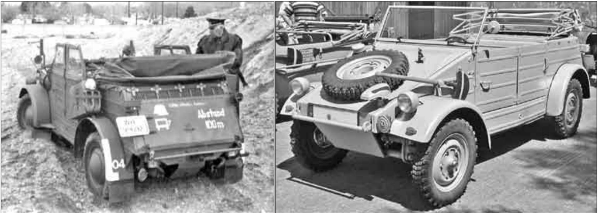
Dos vistas del Kübelwagen, versión alemana del vehículo todoterreno a partir del Volkswagen; plataforma móvil para tres hombres y una ametralladora.
